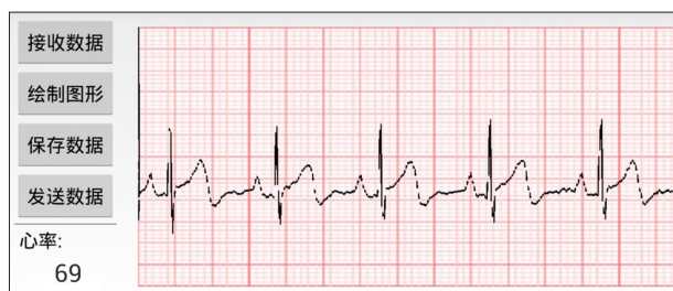
图4 网关系统显示出的心电信号波形和心率信息图
